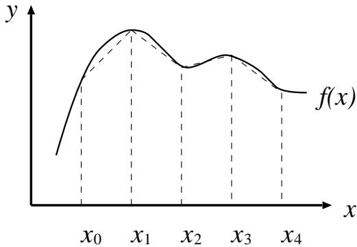
[解説] 積分区間  $[a, b]$  を  $N$  等分し  $x_0 = a, x_1, x_2, \dots, x_N = b$  とし、各点での関数値を  $f(x_0), f(x_1), \dots, f(x_N)$  で表す。図のように関数  $f(x)$  を折れ線で近似すると、各台形の面積は、 $h(f(x_i) + f(x_{i+1}))/2$  で、(積分値  $\approx$  台形の総面積) から上の台形公式が導ける。
